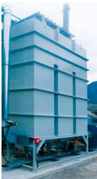
1 – Il sistema d'ossidazione termica rigenerativa (RTO) a 3 torri per il trattamento delle emissioni solventi (Airtreco). Système d'oxydation thermique régénératrice à 3 tours pour le traitement des émissions des solvants (Airtreco).
