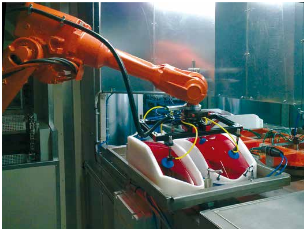
2 – Una fase del processo robotizzato di preparazione e applicazione dell' anti-fog all'interno dei fanali posteriori di automobili (VarnishTech). Une phase du processus robotisé de préparation et application de "anti-fog" à l'intérieur des phares postérieurs des automobiles (Varnish-tech).
